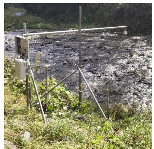
河川工事での活用例 上流の雨量予測 現場の雨量予測 水位の観測値を一元管理し安全対策に役立ちます。
