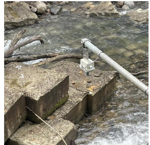
電池式水位計で河川の水位を観測。電源不要で稼働することができます。
