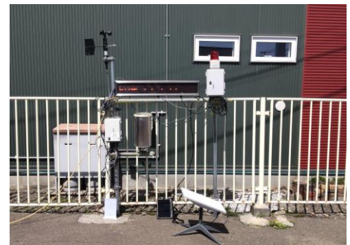
スターリンクで機器を通信。電波が届かない現場でもZEROSAI X-AIならデータ取得をおこなうことができます。
