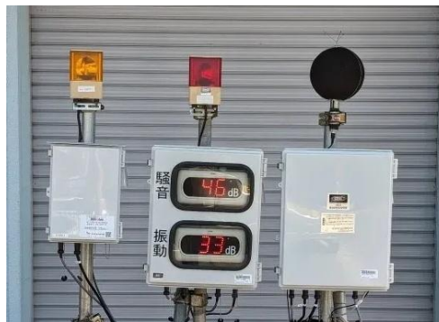
クラウド管理型騒音振動計を取付。気象情報と合わせてさまざまな情報を一元管理することができます。
